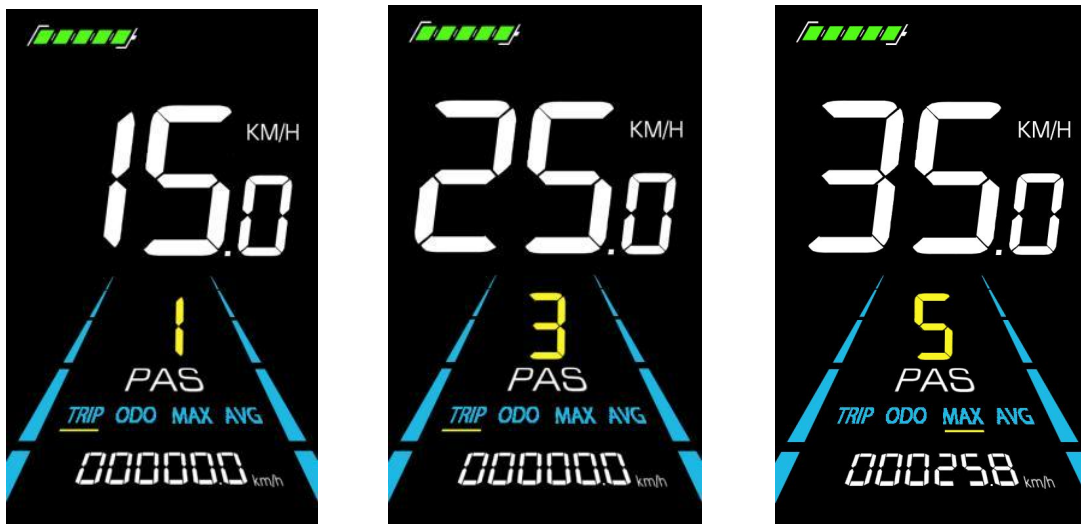
Figure 5-3 PAS level display interface
